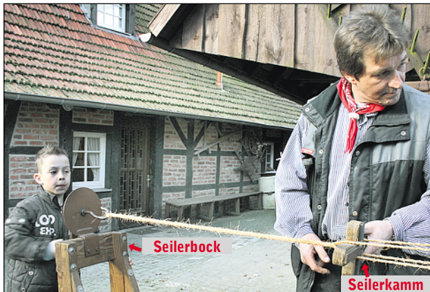
Michael Mersch schiebt den Seilerkamm nach vorne. Joel Manchen beobachtet, wie sich die vier Litzen zum Seil verdrehen.
