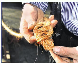
Zum Schluss nimmt Michael Mersch die vier Sisalschlaufen vom Seilerbock ab und arbeitet sie ins Seil ein.
