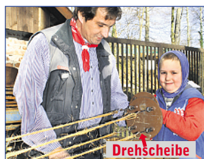
Martin Grundschöttel schlägt durch Drehbewegungen die Sisalfäden zu vier Litzen.
